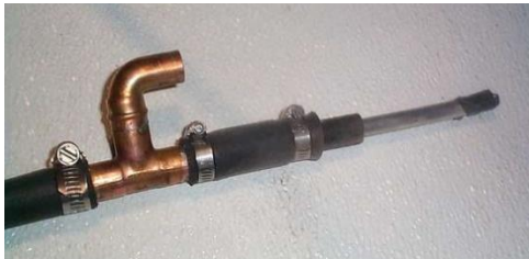
Joonis 2. HIH tüüpi soojendatud kütusevooliku ehitus otsast ja keskelt. (HHIH 2009)
